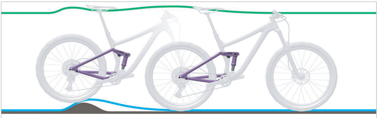
Abbildung 212: Zu harte Dämpfung des Hinterbau-Dämpfers bei Unebenheiten
