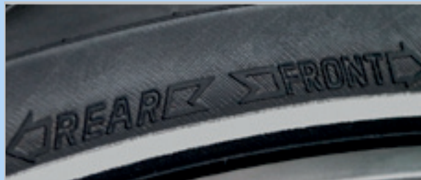
Abbildung 73: Laufrichtungspfeil auf MTB-Reifen
