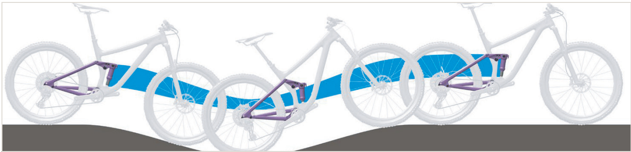
Abbildung 210: Zu weiche Federung des Hinterbau-Dämpfers am Berg
