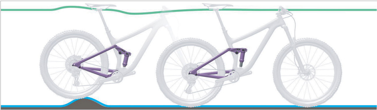
Abbildung 128: Optimales Fahrverhalten des Hinterbau-Dämpfers bei Unebenheiten
