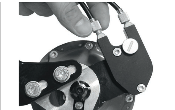
Abbildung 191: ROHLOFF-Naben Versionen mit externer Schaltansteuerung haben die Zugeinsteller an der Seilbox, die sich auf der linken Seite befindet
