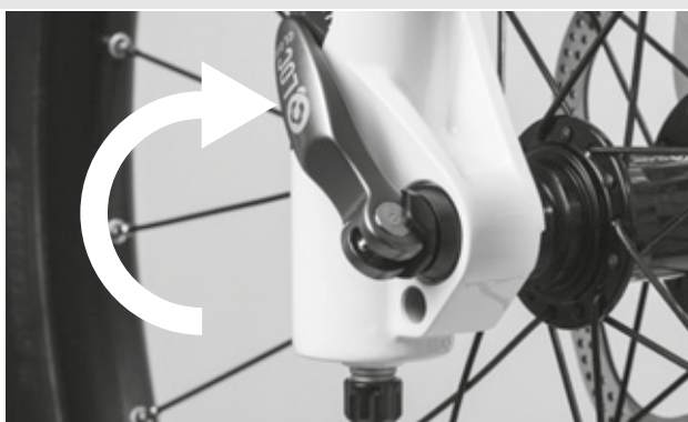
Illustration 43 : Fermer l'attache rapide
