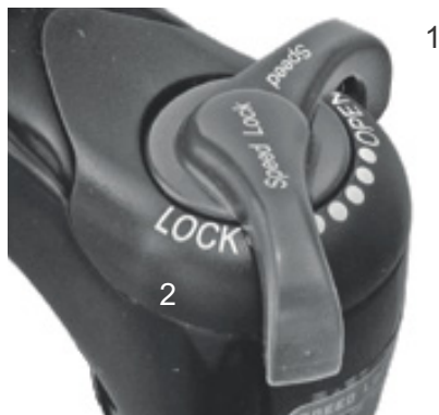
Illustration 79 : Dispositif de réglage de la compression Suntour avec les positions OPEN (1) et LOCK (2)
