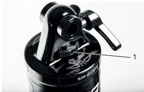
Afbeelding 62: Wiel (1) van de trekdemperafsteller Suntour op de achterbouwdemper
