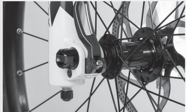
Afbeelding 86: Spankracht van de snelspanner afstellen
