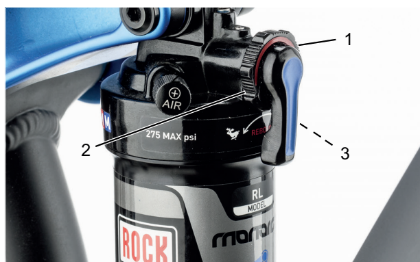
Afbeelding 81: Hardheid van de trekdemper afstellen met het afstelwiel (1) van de achterbouwdemper
