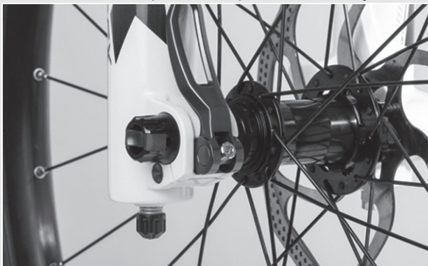
Afbeelding 36: Perfecte stand van de spanhendel
