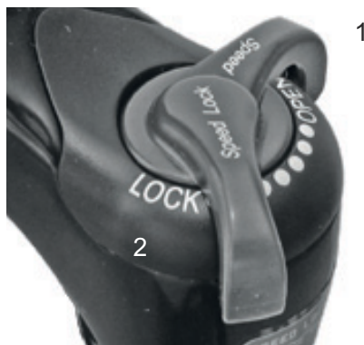
Afbeelding 78: Suntour-drukdemperafsteller met de standen OPEN (1) en LOCK (2)
