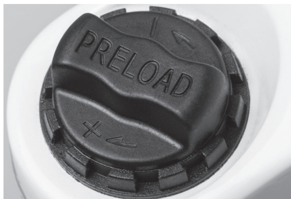
Afbeelding 59: Afstelwiel voor de negatieve veerweg op de kroon van de verende voorvork
