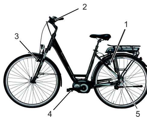
Afbeelding 12: Remsysteem van een pedelec met terugtraprem, voorbeeld
