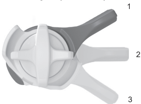
Afbeelding 76: FOX-drukdemperafsteller op de achterbouwdemper met de standen OPEN (1), MIDDEL (2) en HARD (3)
