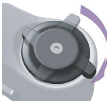
Illustration 117 : Régler le dispositif de réglage de la compression sur un niveau plus dur
