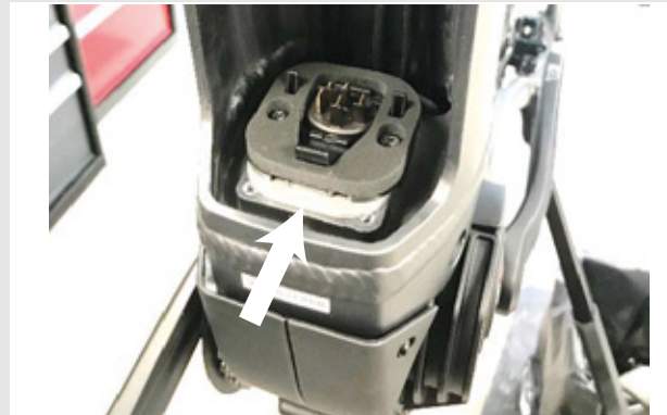
Illustration 39 : Plaques adaptatrices montées
