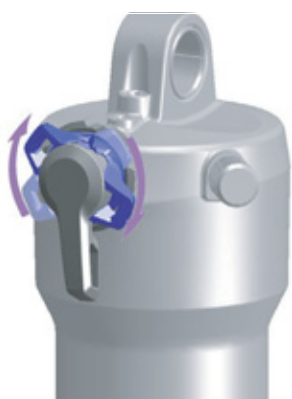
Illustration 141 : Régler le dispositif de réglage de la compression sur un niveau plus dur
