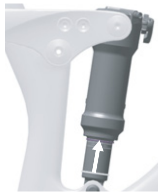
Illustration 84 : Déplacer le joint torique sur l'amortisseur arrière
