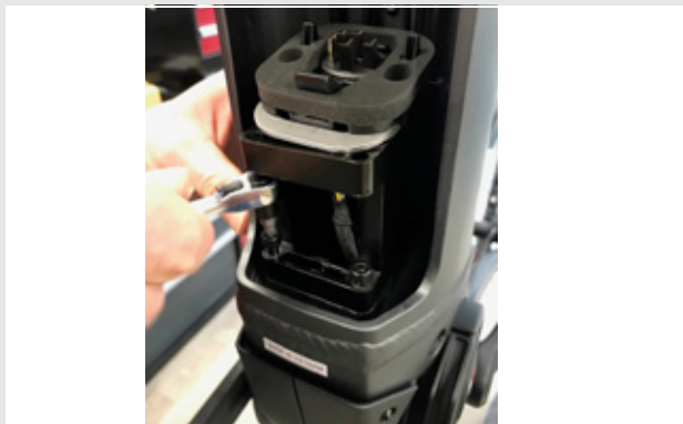
Illustration 36 : Retirer les vis à 6 pans de 4 mm
