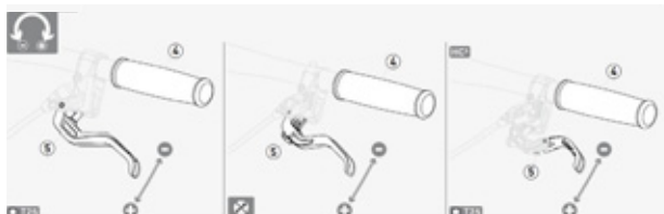
Illustration 75 : Régler la garde d'un levier de frein à disque Magura
