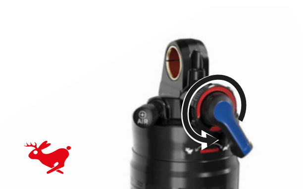
Illustration 91 : Augmenter la vitesse de détente
