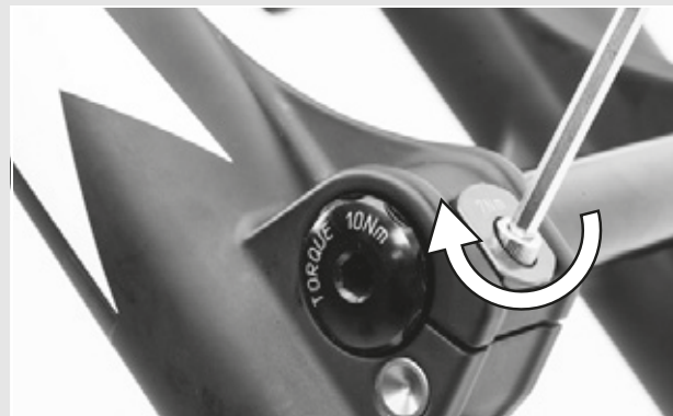
Illustration 53 : Serrer le collier de blocage
