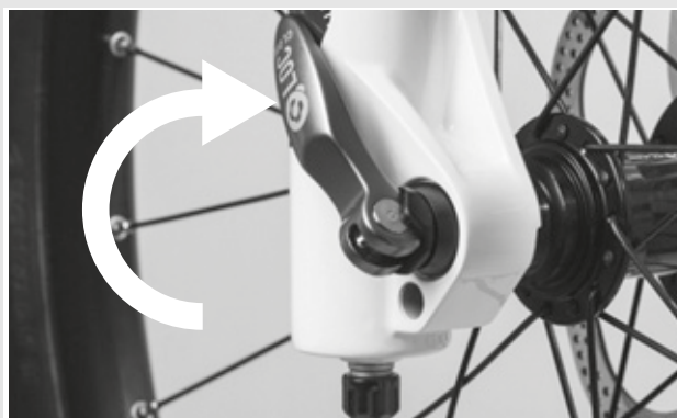
Illustration 63 : Fermer l'attache rapide
