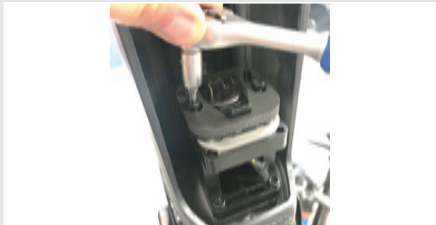
Illustration 35 : Desserrez les vis du logement de batterie
