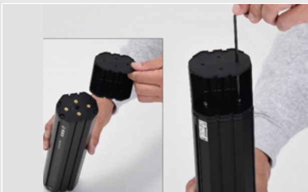
Illustration 45 : Monter l'extension PowerTube
