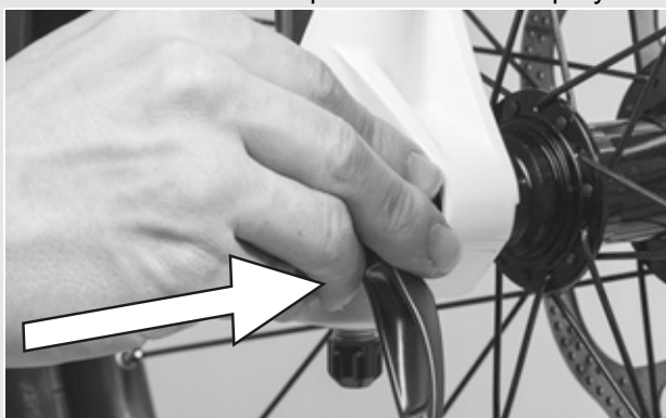
Illustration 61 : Enfoncez l'attache rapide
