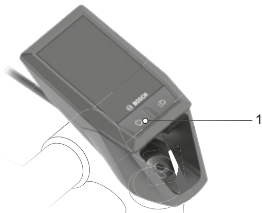
Illustration 107 : Position de la touche Marche/Arrêt (ordinateur de bord)
