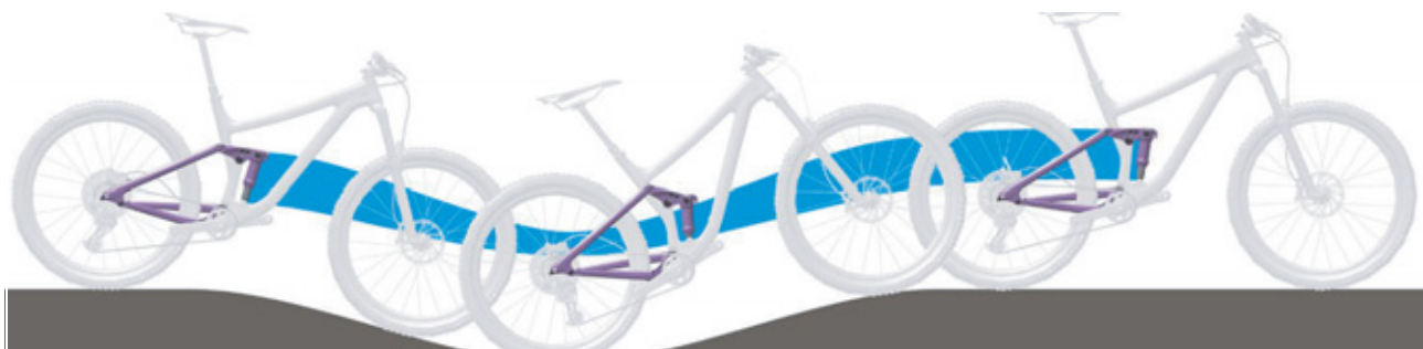
Illustration 140 : Suspension trop souple de l'amortisseur arrière dans les côtes
