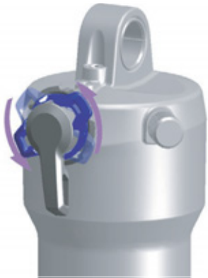
Illustration 143 : Régler le dispositif de réglage de la compression sur un niveau plus souple
