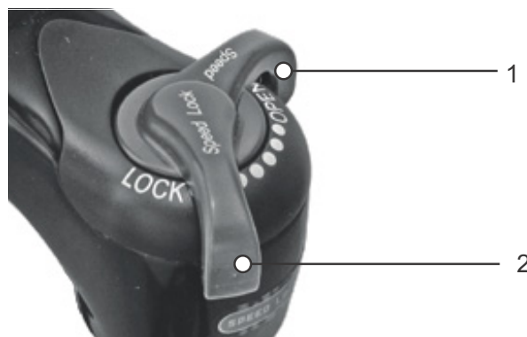
Illustration 116 : Amortisseur de compression Suntour en position ouverte (1) et fermée (2)
