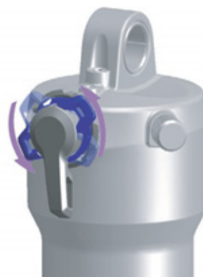
Illustration 96 : Régler le dispositif de réglage de la compression sur un niveau plus souple
