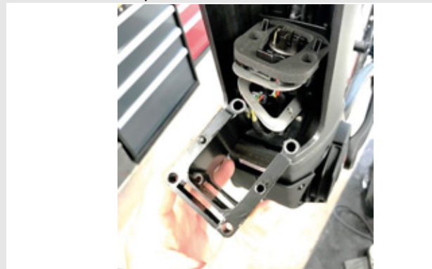
Illustration 38 : Retirer l'adaptateur PowerTube
