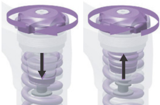
Illustration 79 : Serrer et desserrer l'anneau de réglage de la prétension.
