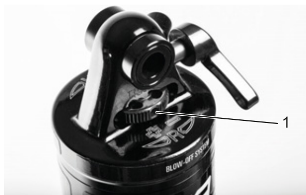
Illustration 88 : Molette de réglage de la détente Suntour (1) sur l'amortisseur arrière
