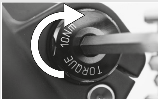
Illustration 52 : Serrer l'axe inséré
