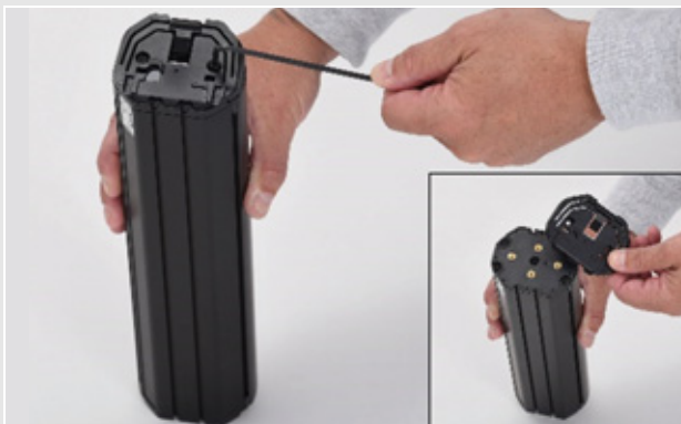
Afbeelding 32: Demontage bovenste interface
