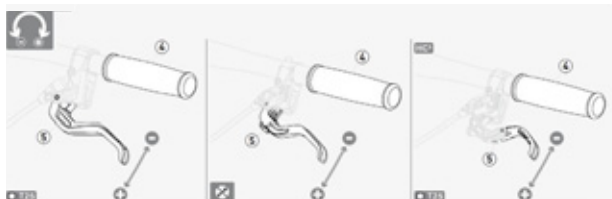
Afbeelding 63: Grijpafstand Magura schijfremhendel afstellen
