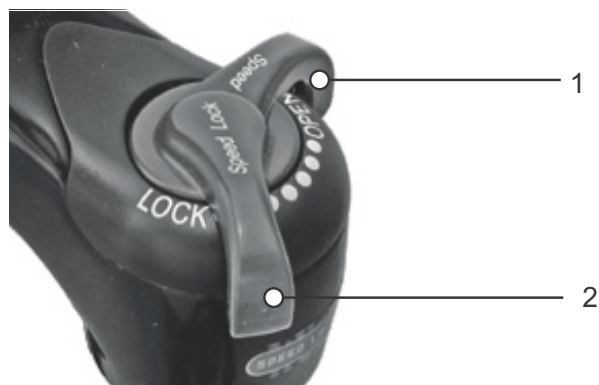
Afbeelding 86: Suntour drukdemper in open (1) en gesloten (2) stand
