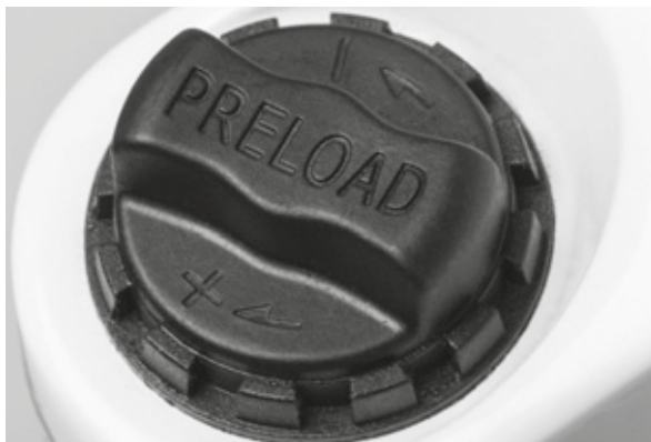
Afbeelding 65: Afstelwiel voor de sag op de kroon van de verende voorvork
