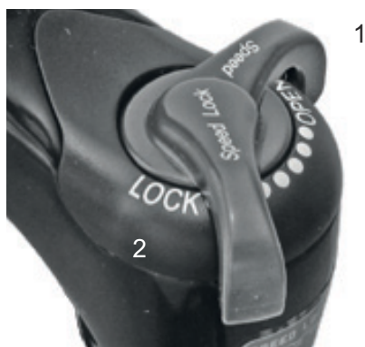
Abbildung 77: Suntour-Druckstufeneinsteller mit den Positionen OPEN (1) und LOCK (2)
