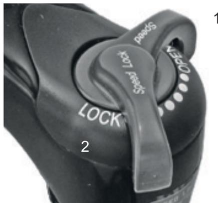
**Abbildung 57:** Suntour-Druckstufeneinsteller mit den Positionen OPEN (1) und LOCK (2)
