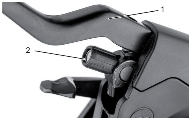
Abbildung 67: Bremshebel (1) der hydraulisch betätigten Felgenbremse mit Einstellschraube (2)
