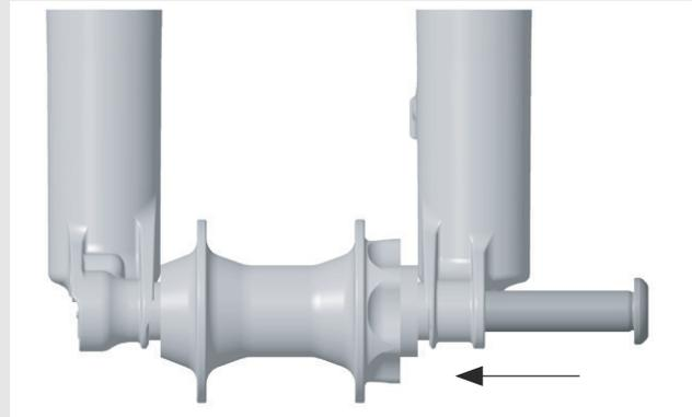
Abbildung 30: Kabolt-Achse einschieben
