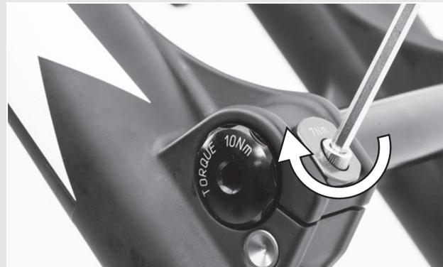
Abbildung 16: Sicherheitsklemme anziehen
