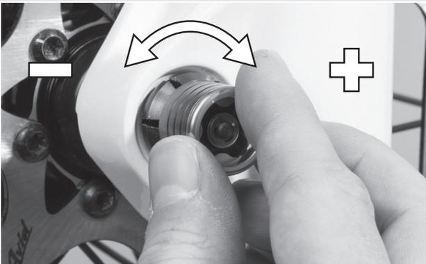
Abbildung 25: Spannung einstellen
