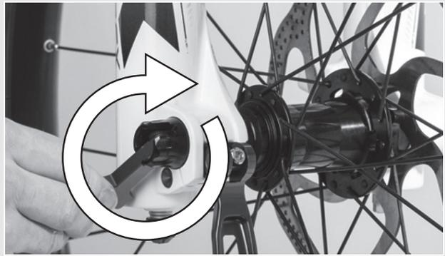
Abbildung 18: Achse anziehen
