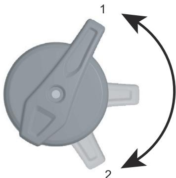
Abbildung 50: FOX-Druckstufen-Einsteller mit den Positionen OFFEN (1) und HART (2)
