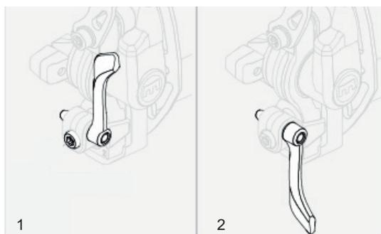
Abbildung 7: Verriegelungshebel der Felgenbremse, geschlossen (1) und geöffnet (2)
