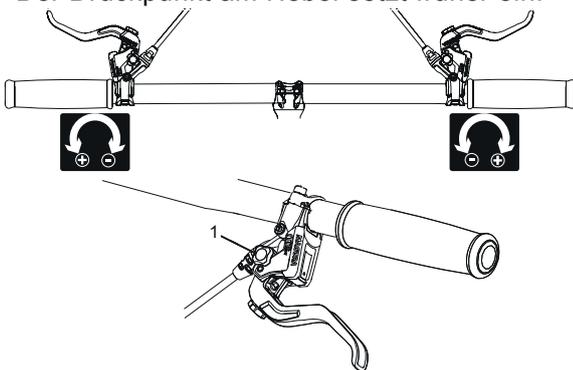
Abbildung 42: Benutzung des Drehknopfs (1) zur Druckpunkt-Einstellung
