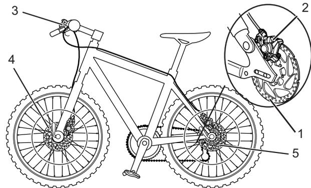
Abbildung 8: Bremssystem mit Scheibenbremse, Beispiel
