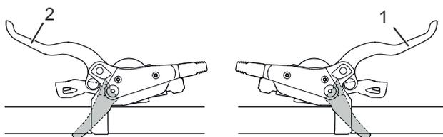
Abbildung 48: Bremshebel hinten (1) und vorne (2),
