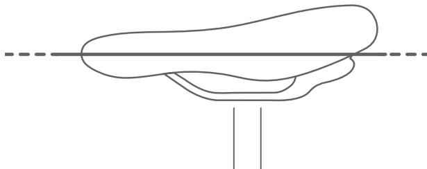
Abbildung 31: Waagerechte Sattelneigung
