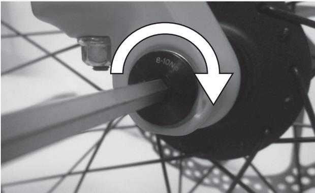
Abbildung 12: Achse anziehen
