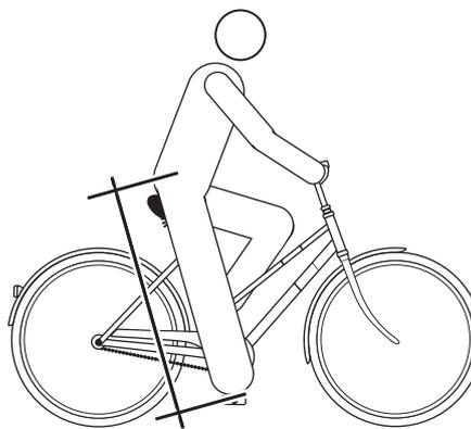
Abbildung 32: Optimale Sattelhöhe
