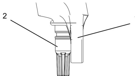
Abbildung 45: Suntour-Zugstufen-Schraube (2), Gabel (1)
