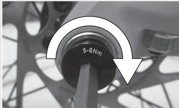
Abbildung 14: Sicherungsschraube anziehen
