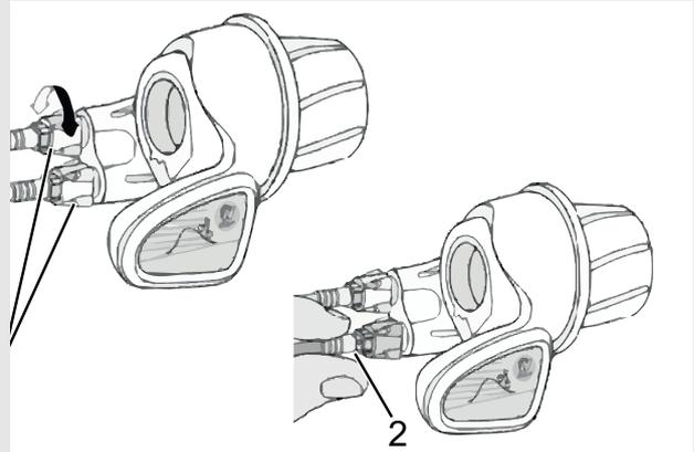
Abbildung 58: Drehgriffschalter mit Einstellhülsen (1) und Spiel der Gangschaltung (2).
