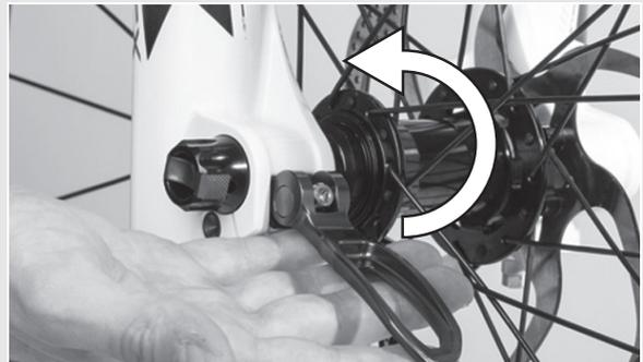
Abbildung 20: Hebel sichern
