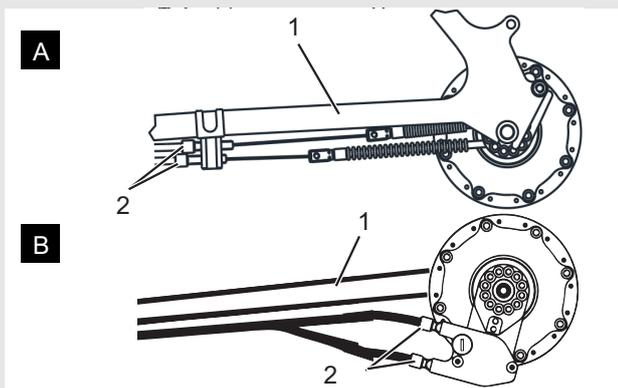
Abbildung 57: Einstellhülsen (2) an zwei alternativen Ausführungen (A bzw. B) einer zweizügigen, seilzugbetätigten Gangschaltung an der Kettenstrebe (1)
