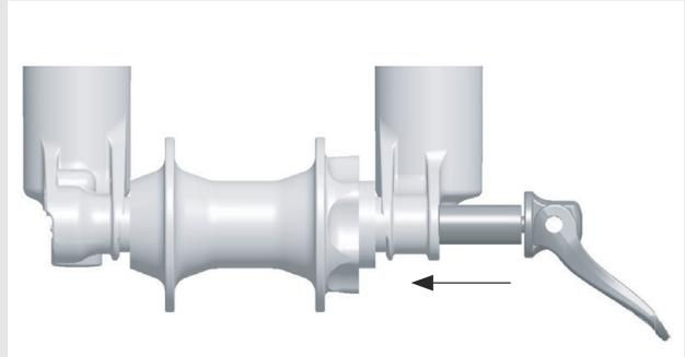
Abbildung 27: Schnellspanner einschieben
