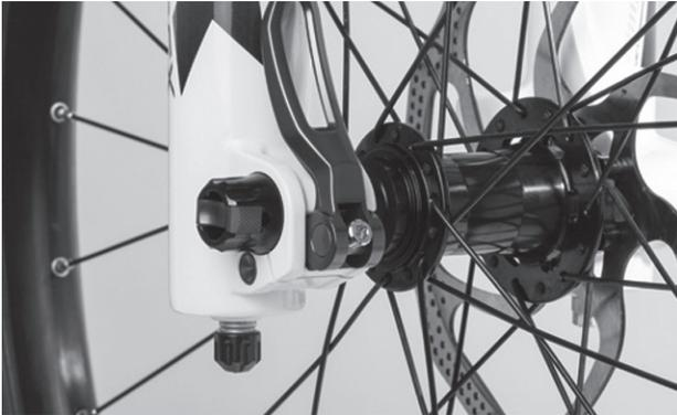
Abbildung 21: Perfekte Lage des Spannhebels
