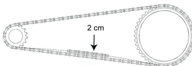
Abbildung 53: Kettenspannung prüfen
