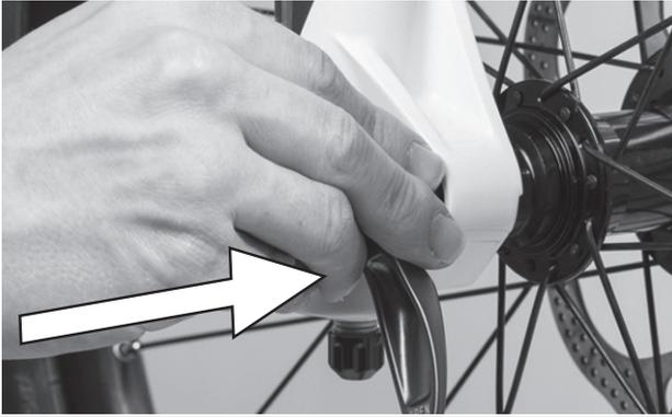
Abbildung 24: Schnellspanner hineinschieben
