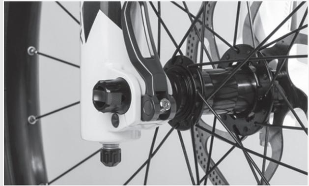
Abbildung 54: Spannkraft des Schnellspanners einstellen
