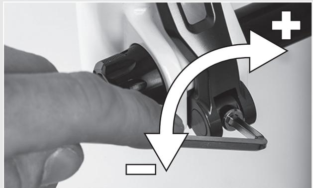
Abbildung 55: Spannkraft des Schnellspanners einstellen
