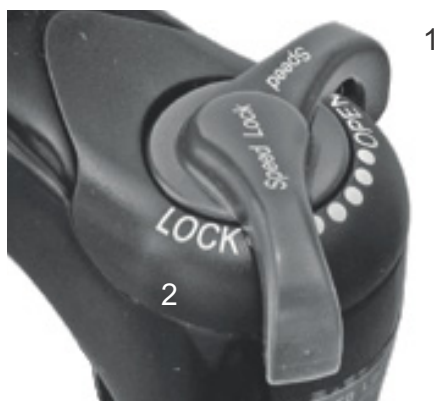
Afbeelding 55: Suntour-drukdemperafsteller met de standen OPEN (1) en LOCK (2)
