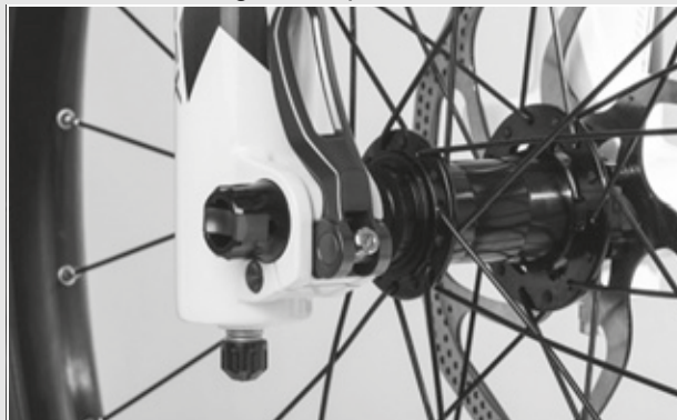
Illustration 46 : Position parfaite du levier de serrage
