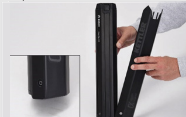
Illustration 31 : Enfoncer le capot de batterie sur la batterie
