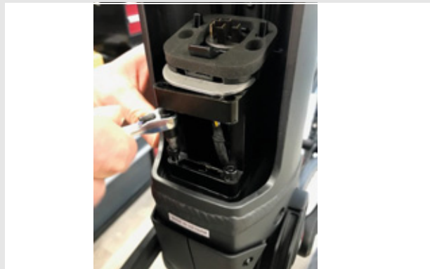
Illustration 24 : Retirer les vis à 6 pans de 4 mm
