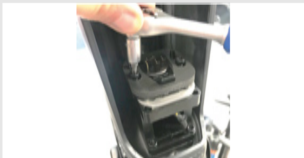
Illustration 23 : Desserer les vis du logement de batterie
