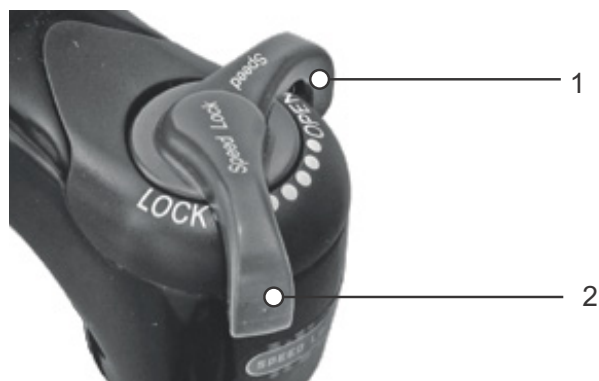
Illustration 86 : Amortisseur de compression Suntour en position ouverte (1) et fermée (2)
