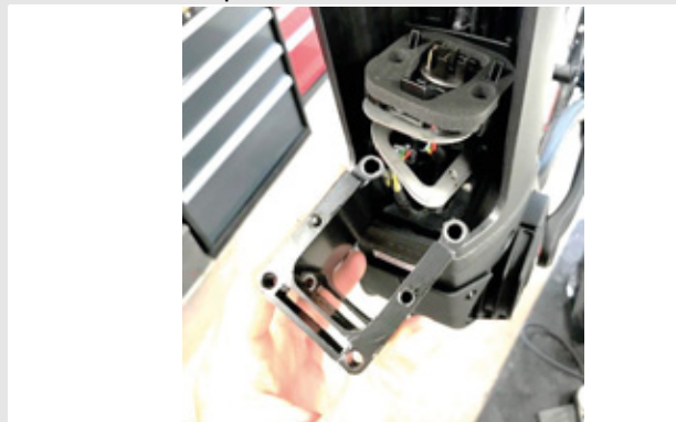
Illustration 26 : Retirer l'adaptateur PowerTube
