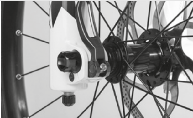
Illustration 91 : Régler la force de serrage de l'attache rapide
