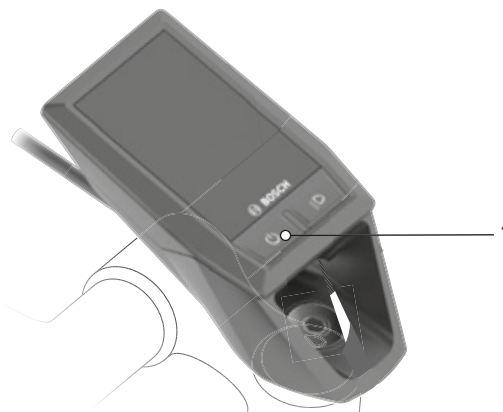
Illustration 77 : Position de la touche Marche/Arrêt (ordinateur de bord)
