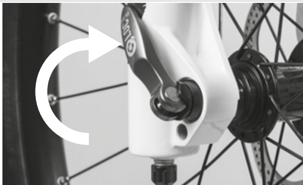
Illustration 51 : Fermer l'attache rapide
