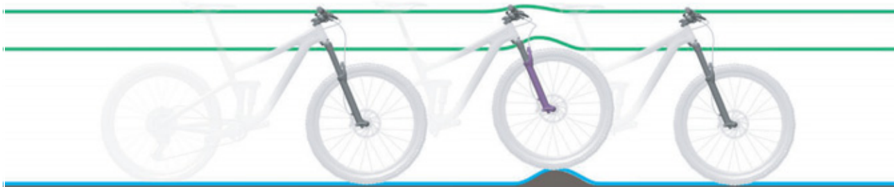
Illustration 85 : Comportement optimal sur les irrégularités
