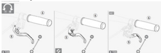
Illustration 63 : Régler la garde d'un levier de frein à disque Magura
