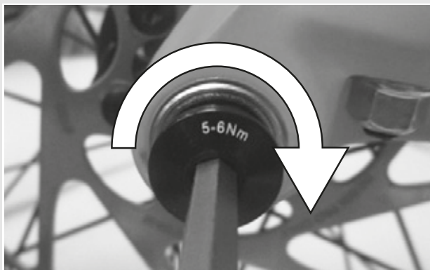
Illustration 39 : Serrer la vis de blocage
