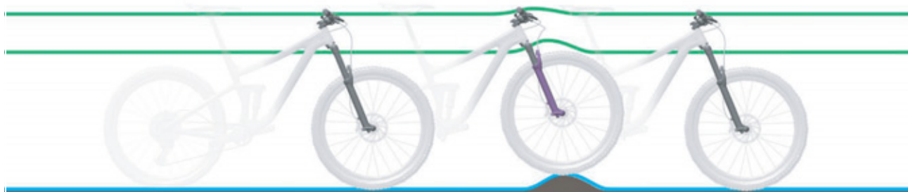
Illustration 6 : Comportement optimal de la fourche sur les irrégularités
