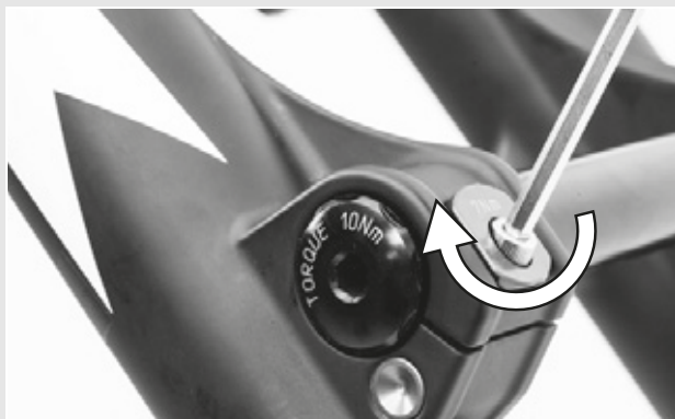
Illustration 41 : Serrer le collier de blocage
