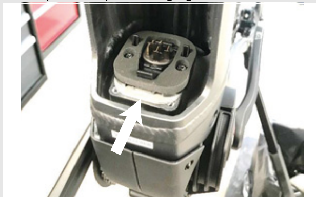
Illustration 27 : Plaques adaptatrices montées
