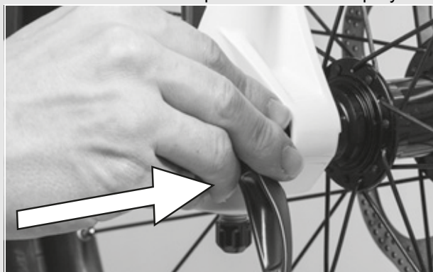
Illustration 49 : Enfoncez l'attache rapide
