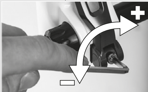
Illustration 47 : Régler la force de serrage de l'attache rapide
